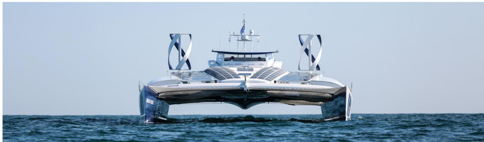
Desenvolvidos com o ICAM de Nantes, foram escolhidos pela ausência de ruído, pelo sistema antivibração e pela capacidade de captar o fluxo do vento independentemente da sua direção. O objetivo era diversificar o mix energético do navio e aproveitar a energia eólica à noite ou em condições de sol baixo.
